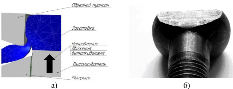
Рис. 3. Образование сколов на гранях опорной поверхности головки: а – моделирование МКЭ; б – эксперимент
