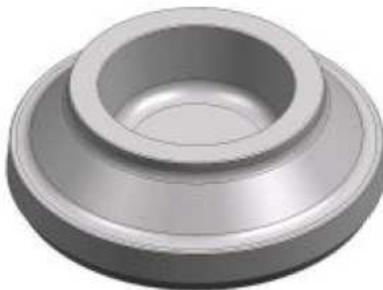
Вращательный диск для двигателя GE90-115B. Компания Ladish
