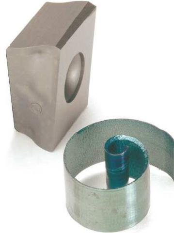
*На рисунке показана вставка Ingersoll S-MAX и форма образующейся стружки. Форма стружки так же сравнивается с результатами моделирования.*
