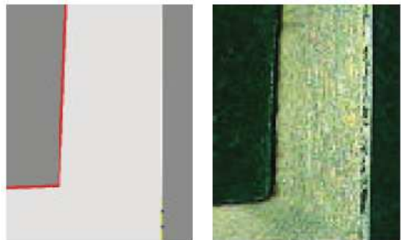
В результате моделирования в программе DEFORM (рисунок слева) было показано хорошее заполнение с учета воздухоотводящих каналов в инструменте. Контакт инструмента с заготовкой показан красной линией. Реальное заполнение показано на правом рисунке.
