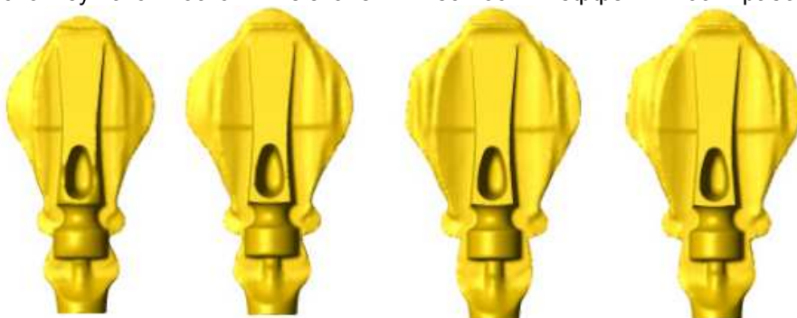
На рисунке показано влияние жесткости молота на прогнозирование результатов штамповки в чистовом ручье. Заполнение полости штампа и облой увеличиваются по мере увеличения жесткости. При самой высокой жесткости форма изделия выглядит хорошо, но трудно спрогнозировать количество ударов.
