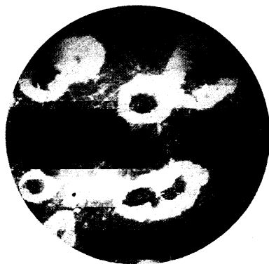
Рис. 2. Микроструктура чугуна с шаровидным графитом в ферритной матрице после горячей пластической деформации со степенью деформации по высоте \varepsilon_h = 10\% и охлаждения на воздухе, \times 300
