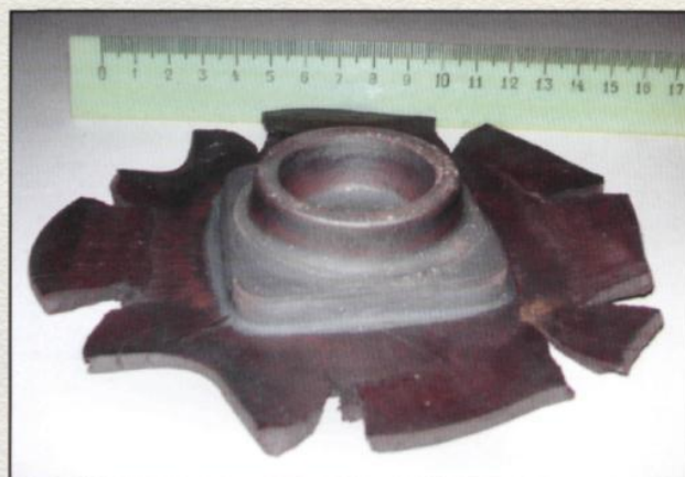
Рис. 4. Поковка на деталь "фланец" с необрезанным технологическим заусенцем (облоем)
