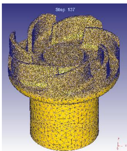
Рис. 5. Заготовка и график изменения энергии во времени: а – после осадки; б – после операции выдавливания
